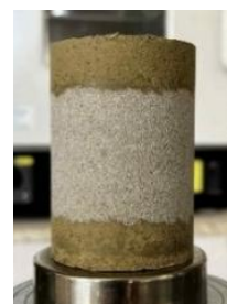
図 2.4 端部に粘土処理
