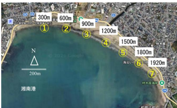
図9 由比ガ浜海岸の水深測量における側線
