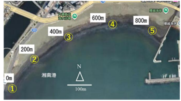
図10 片瀬東浜の水深測量における側線
