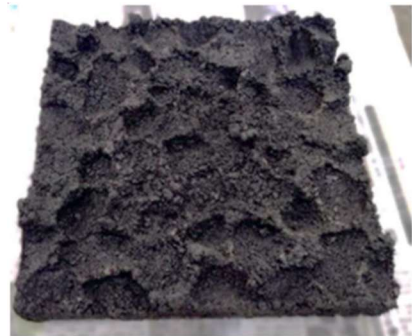
写真-2.2 供試体下面（バラスト側）の状況
