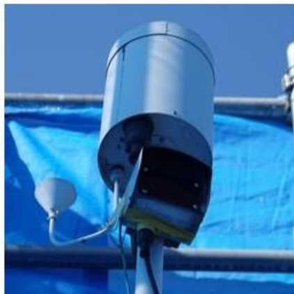
図 3.3 本研究で用いる田村式降水量計と仕組み
