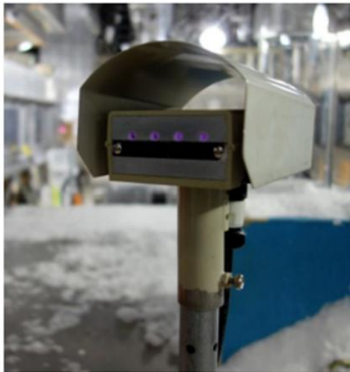
図 3.1 光学式反射型固体降水観測器(PDS)
