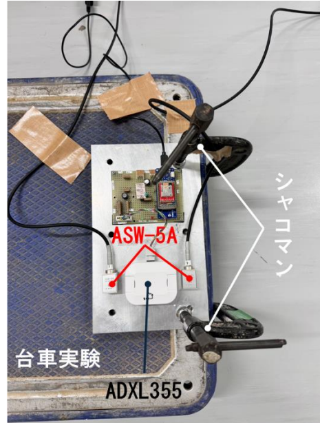
図2-1 台車における加振実験の固定方法
