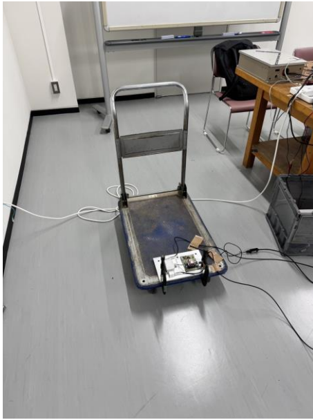
図2-1 台車における加振実験の固定方法
