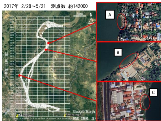
図-3 斜面崩壊の危険性が高い箇所
