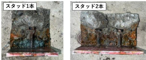
図 3-1 コンクリート内部のひび割れ状況
