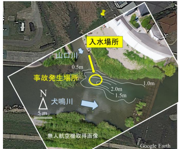
図-9 測深器を用いた測定結果
