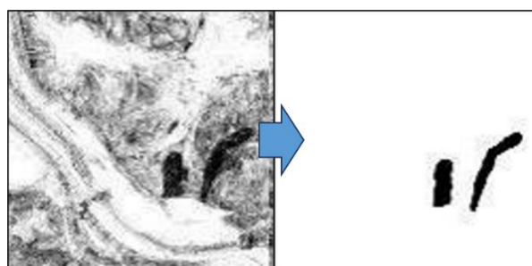
図 3 画像認識で抽出された危険箇所
