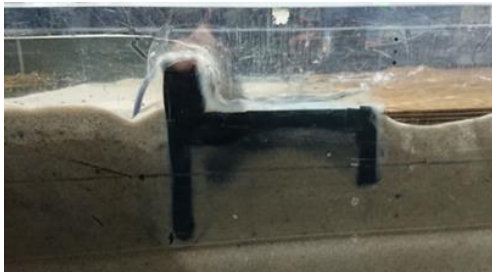
図6 矢板内側にインクを注入して得られた部分的な流脈
