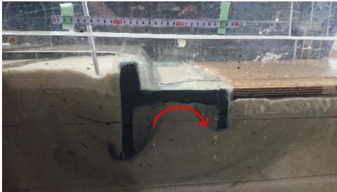
図4 流脈が途切れる写真(一か所穴の開いたパイプの場合)
