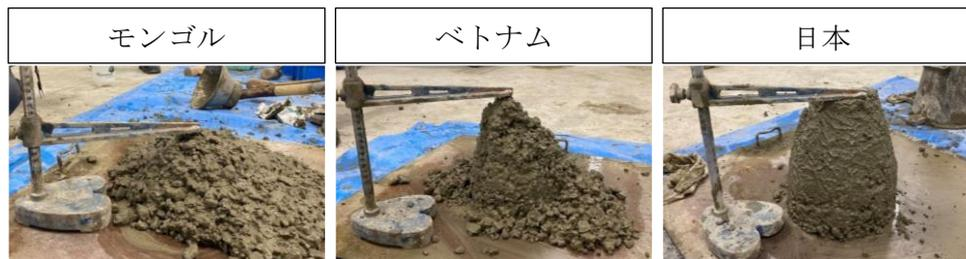
図-4 スランプ試験の結果
