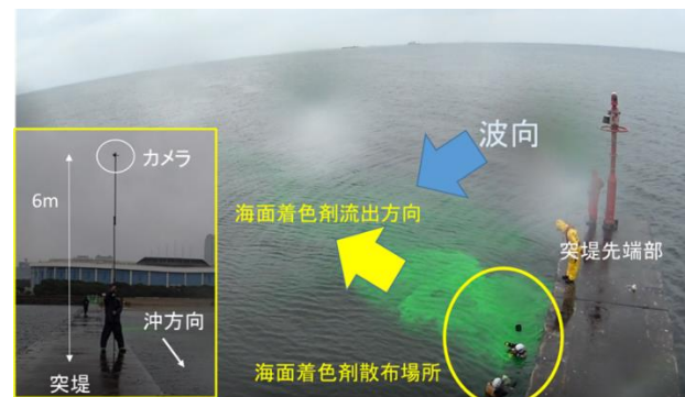
図 3.3.1 突堤先端部の海面着色剤流出状況
