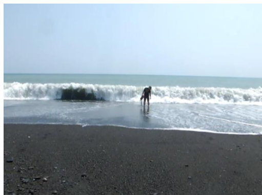
写真-4 最大波と思われる波浪砕波状況 (水位: 0.89m, 流速 2.36m/s, 2019年8月19日12時41分頃)
