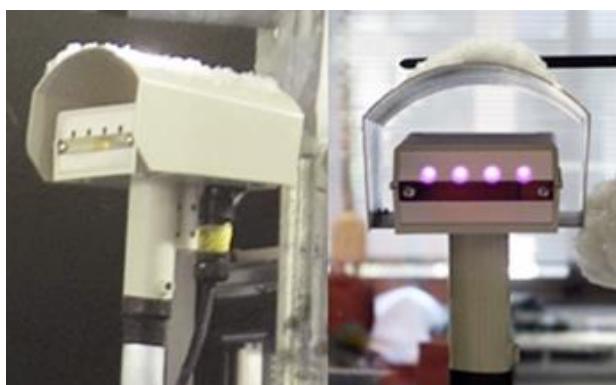
図 1 光学式反射型固体降水観測器(PDS)
