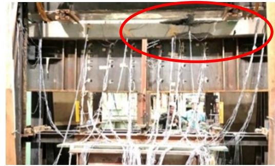
図-5 床版の圧壊
