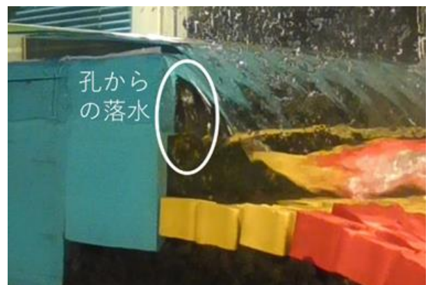
図-5 有孔実験孔からの落水例
