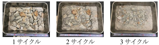
図-4 スレーキング率試験
