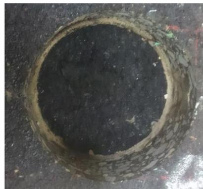
写真-1 (a) 治具側の破壊断面
