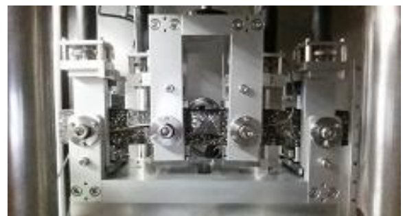
写真-1 4点曲げ疲労試験の実施状況
