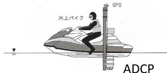
図-2 水上バイクによるADCP移動観測
