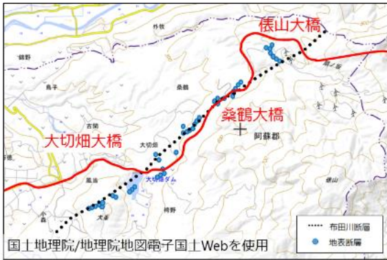
図 1 県道 28 号線の橋梁と地表断層
