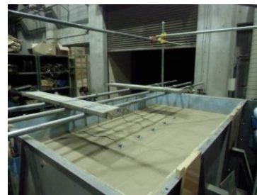
Fig 5 実験土槽の外観
