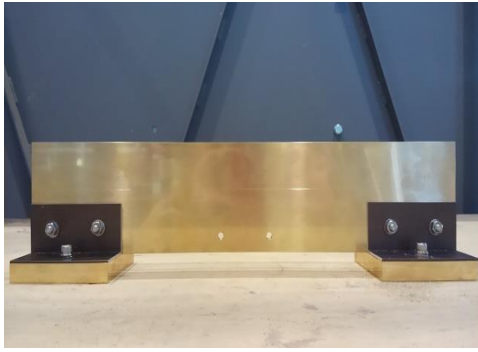
Fig 2 おもりを取り付けた防振壁（上下逆）
