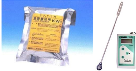
写真-2 離岸流把握器材 (左:海面着色剤, 右:流速計)
