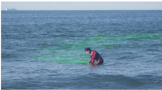
写真-3 海面着色剤散布状況 (緑色の着色水が離岸流にのり沖へ流出)
