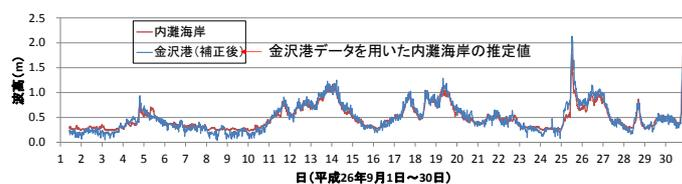
図4 内灘海岸と金沢港(補正後)の波高経時変化 (平成26年9月1日～30日)
