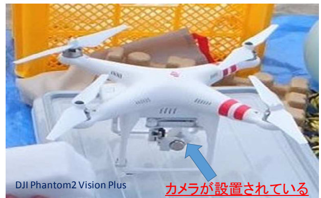
図-7 使用した UAV(ドローン)
