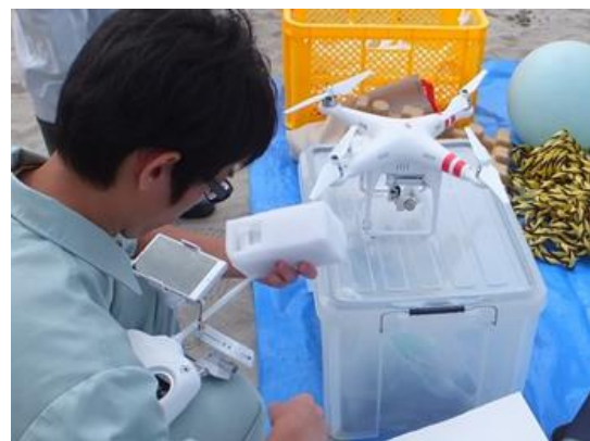
写真1 空撮用 UAV (無人航空機)
