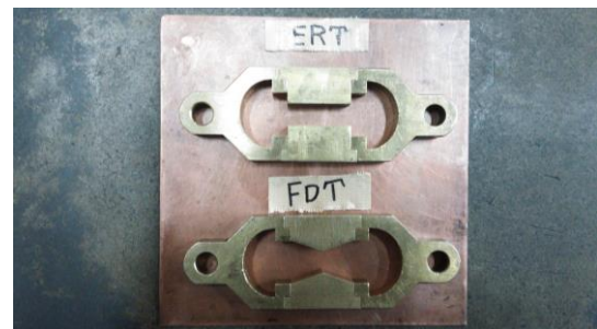
図-1 試験に用いる型枠
