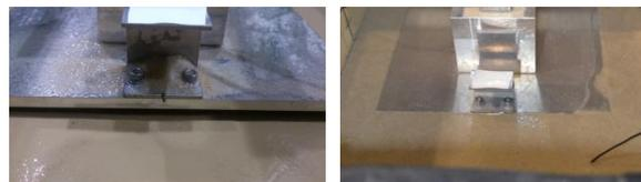
写真-1 加振後の堰の様子
