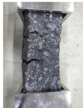
写真3 2層での試験後の状況
