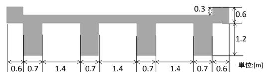
図-4 解析における橋桁の寸法
