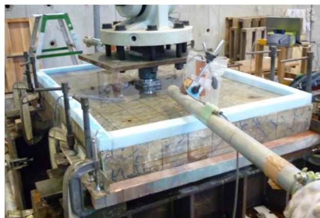
図 - 8 疲労試験状況(水中)
