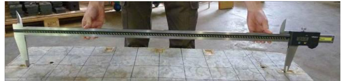
図-2 ノギスによる膨張量測定状況
