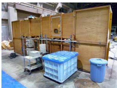
写真 - 1 風洞型飛来塩分再現装置
