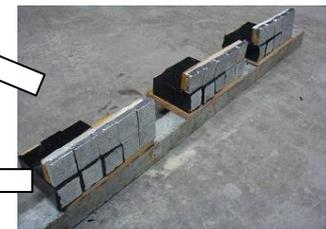
写真 - 5 暴露供試体
