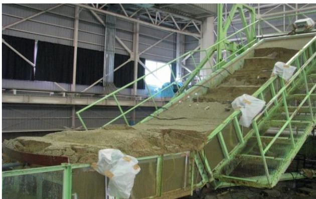
**Photo. 3.2** 崩壊直後の模型斜面 (case2)
