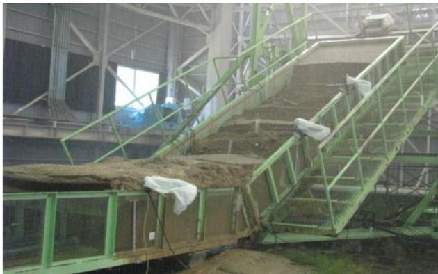
**Photo. 3.1** 崩壊直後の模型斜面 (case1)
