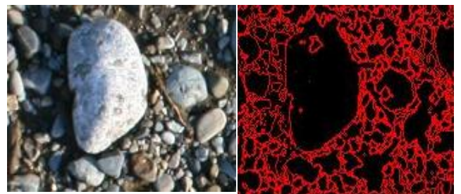
図13. 画像解析前と輪郭抽出後の河床材料画像
