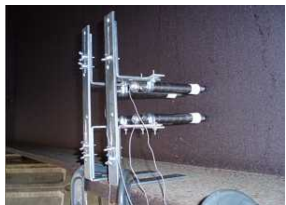
写真 2 直流抵抗測定端子の設置状況
