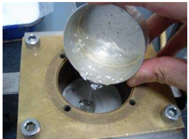
Fig.1 K滑材の設置状況
