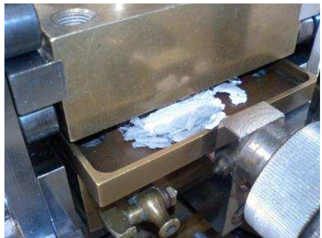
Fig.16 ベントナイト滑材と粘土試料の漏出状況
