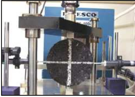
写真1 間接引張試験の実施状況
