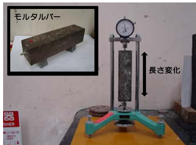
写真-1 モルタルバーの長さ変化の測定
