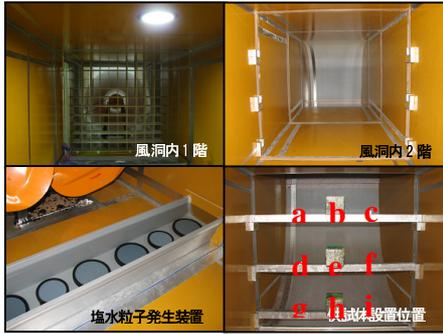
図3. 試験装置内部の様子
