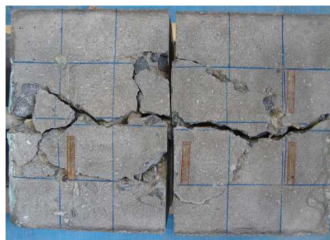
図 - 10 剥離破壊の例 (No.6)
