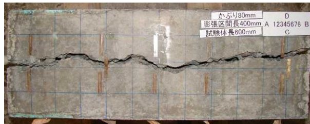
図 - 8 割裂破壊の例 (No.3)
