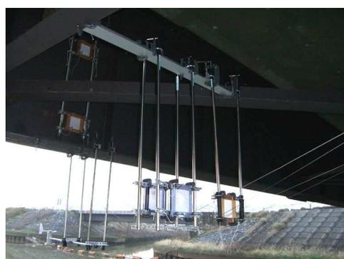
図 - 2 ドライガーゼ法捕集器具
