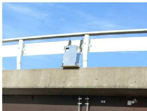
図-3 ドライガーゼ法捕集器具
