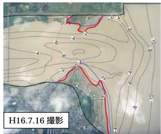
図 8 計算結果と空中写真の砂洲汀線比較
