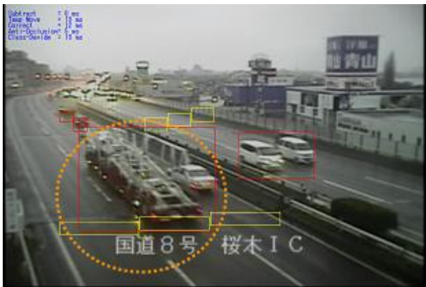
図-8 交通量が少なく計測されるケース 2
