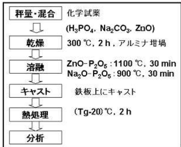
Fig.1 大気下で溶融したガラスの作製法
