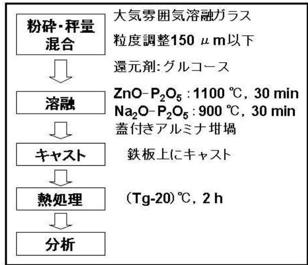
Fig.2 還元雰囲気中で熔融したガラスの作製法
