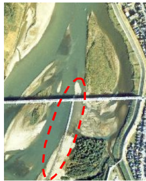
図9 導流堤 (赤点線)
