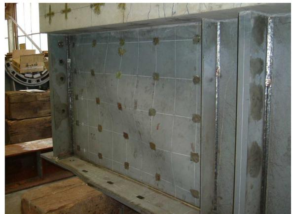
写真4 ウェブの面外変形(2重合成)
