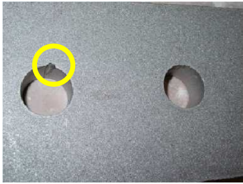
写真-2 溶損ノッチ
