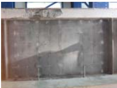
写真-2 負曲げ試験体の圧壊状況
