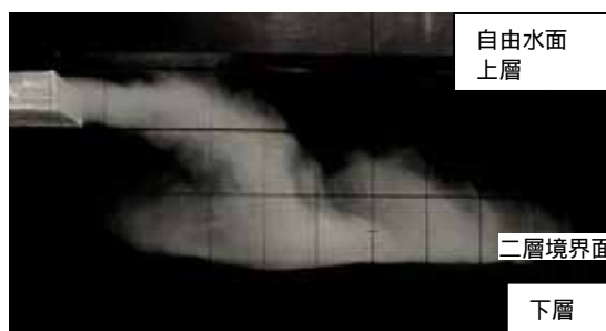
写真 2 水面付近より進入したときの流況
