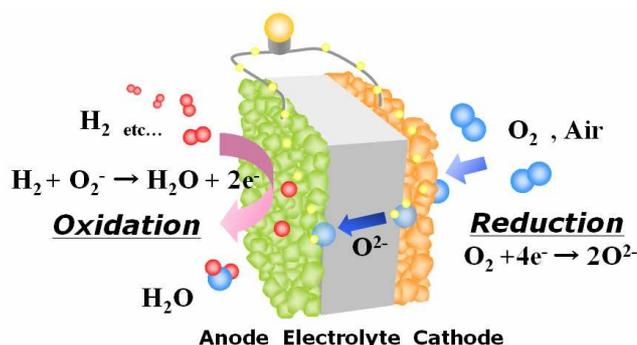
図 1 燃料電池動作概略図
